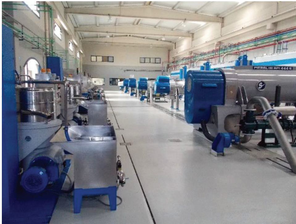
Figure 7. Two-phase decanters in series in an olive mill for the extraction of olive oil (Picualia, Proyecto de traslado y perfeccionamiento de almazaras por fusión de Cooperativas 'Agrícola de Bailén virgen de Zocueca', Jaén, Spain) (Source: Marco Nuti).
