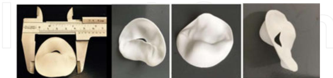
**Figure 6.** A–D. 3D printed model of mitral valve prolapse from 3D ultrasound (3D US)—printed in poliamide—(EOS P110)—Instituto Nacional de Tecnologia—Laboratório de Modelos Tridimensionais—Ministério da Ciência, Tecnologia e Inovação.
