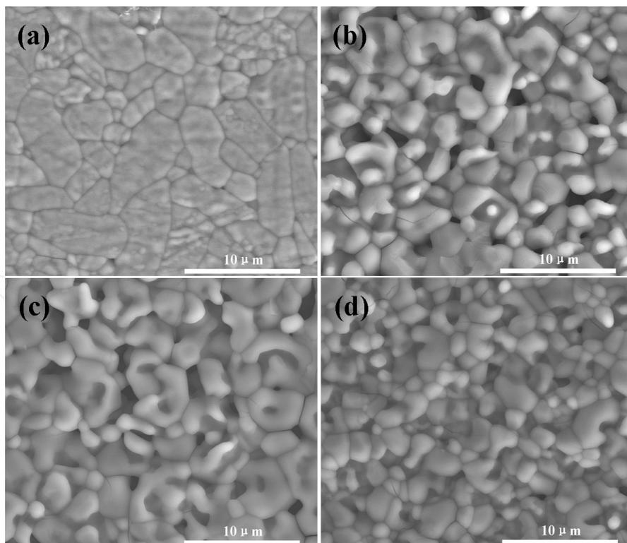
Figure 6. SEM images of surface section of SPS-sintered  $\text{YCr}_{1-x}\text{Mn}_x\text{O}_3$  ceramics: (a)  $x=0$ ; (b)  $x=0.2$ ; (c)  $x=0.4$ ; (d)  $x=0.5$ .
