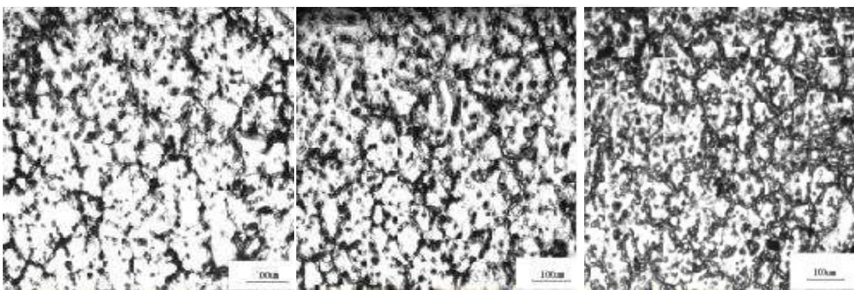
(a) 500r/min, 10min, 3Vol.% (b) 500r/min, 10min, 6Vol.% (c) 500r/min, 10min, 9Vol.%
