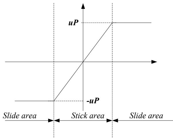
Fig. 13. A Friction Model
