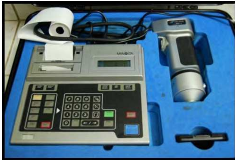
Fig. 1. Minolta Cr 200 colourmeter (Beyaz, 2009a).
