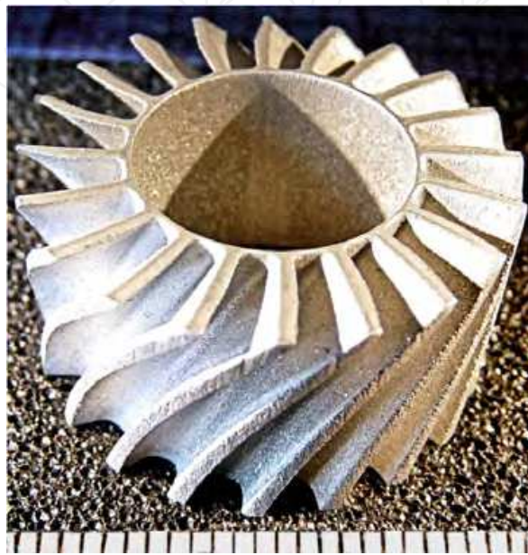
Fig. 21. A-Jet-machined aluminum blisk. Scale: mm.
