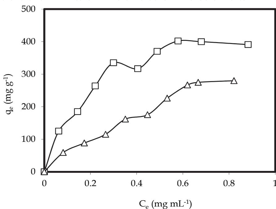
Fig. 4. The adsorption isotherms of biomolecules ( $\Delta$ :casein,  $\square$ :catalase) onto sepiolite. (Experimental cond. 22°C, pH 7,  $[\text{PO}_4^{3-}]$ : 0.02 M,  $[\text{NaCl}]$ : 0.001 M)
