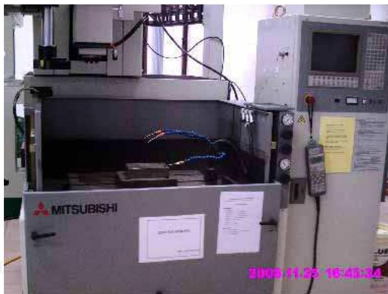
Fig. 3. EDM die sinking machine
