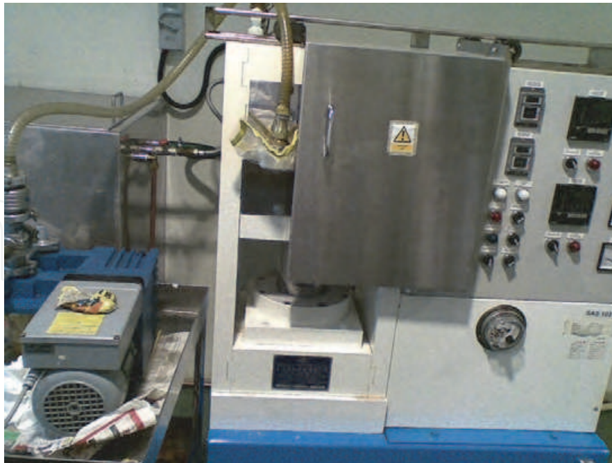
b) Actual hot press setup
