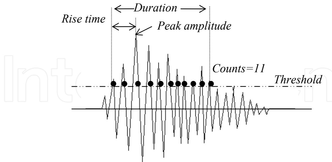
Fig. 2. Definition of AE waveform parameters
