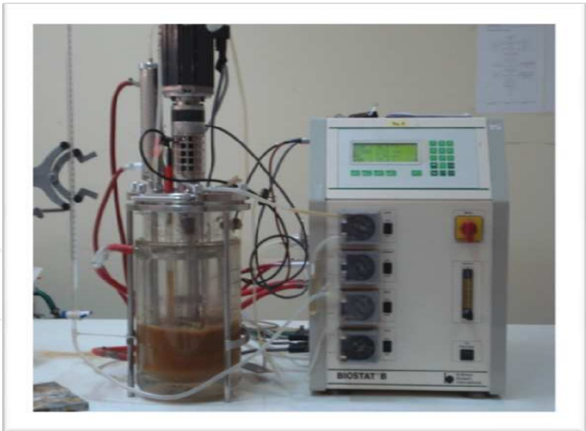
Fig. 4. Fermentation of sweet sorghum in fermentor (Kaewkannetra et al., 2008)
