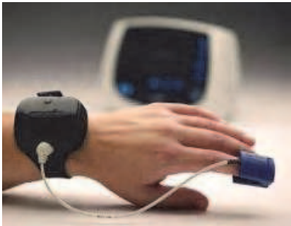
Fig. 11. Wireless Oximeter (Nonin (n.d)).
