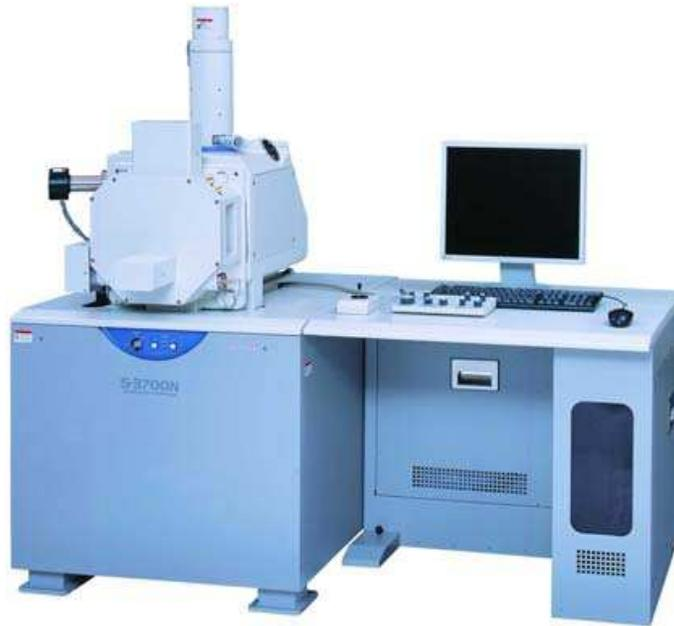
Fig. 8. A Hitachi 3700N SEM instrument ([www.hht-eu.com](http://www.hht-eu.com))
