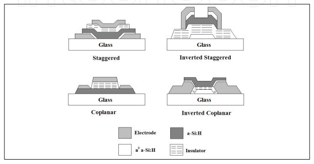
Fig. 2. Basic a-Si:H TFT structures.
